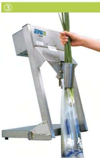
③ スイッチを入れると、吹き出し口からの風により、袋が自動的に開くので商品をホッパーの中に投入します。
