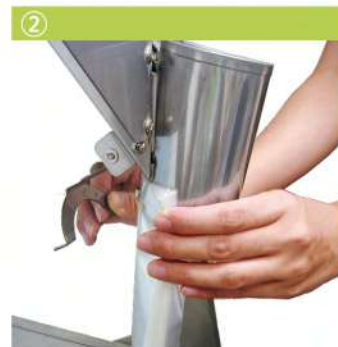
② 本体をホッパーの後部にあるフックに専用袋を取り付けます。袋の開口部が密着(ブロッキング)して開きにくい場合があるので、一度開口部を軽くもみほぐしてから袋をセットしてください。
